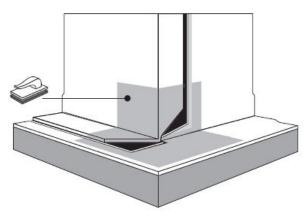
Positionieren Sie das Anschlussstück mit seiner Mitte auf der Außenkante. Falten Sie beide Seiten um die Ecke und verkleben Sie sie mit der vertikalen Aufkantung.
